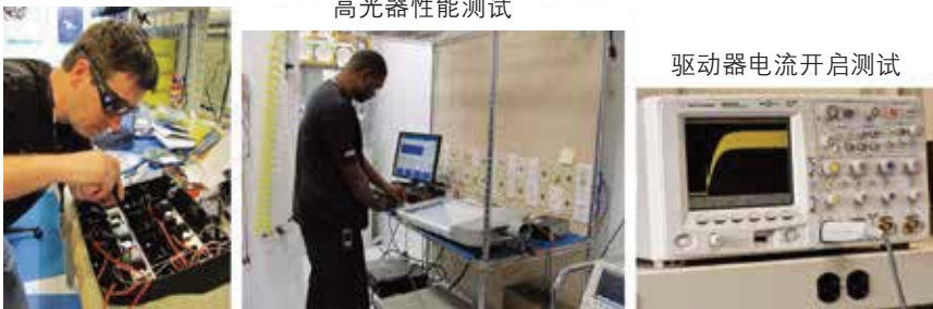
图 3. 电测试应该包括可能导致产品失效的瞬态分析, 和亮度调节器兼容性测试来确保产品将能满足消费者的预期。
