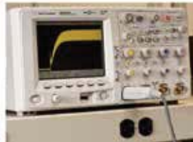
图 3. 电测试应该包括可能导致产品失效的瞬态分析, 和亮度调节器兼容性测试来确保产品将能满足消费者的预期。
