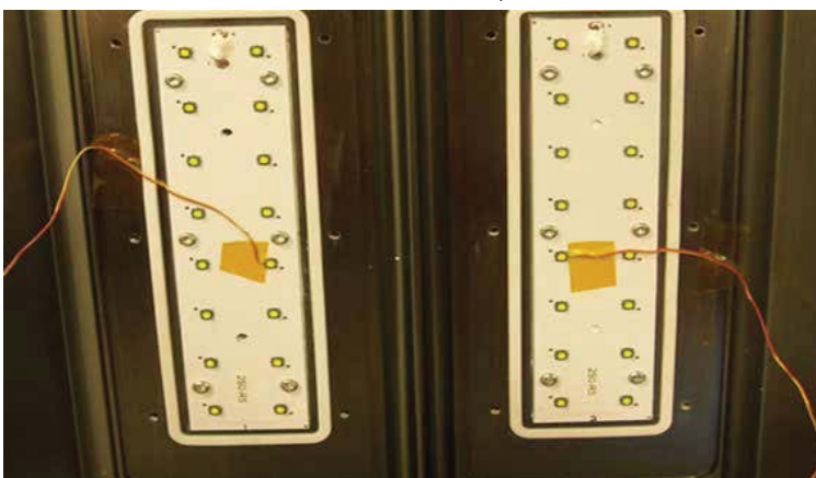
图2. 针对半导体照明产品的热和机械测试可以发现其中的设计或制造缺陷。
